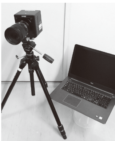
(上) レーザー顕微鏡／材料の超高倍率観察と3D測定ができます。 (左) 高速度ビデオシステム／1秒間に最大90万枚の映像を撮影できます。
